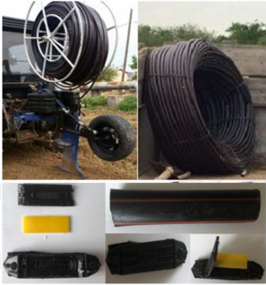
Şekil 3.7 Yüzeyaltı damla sulama laterali ve in-line yassı damlatıcı
