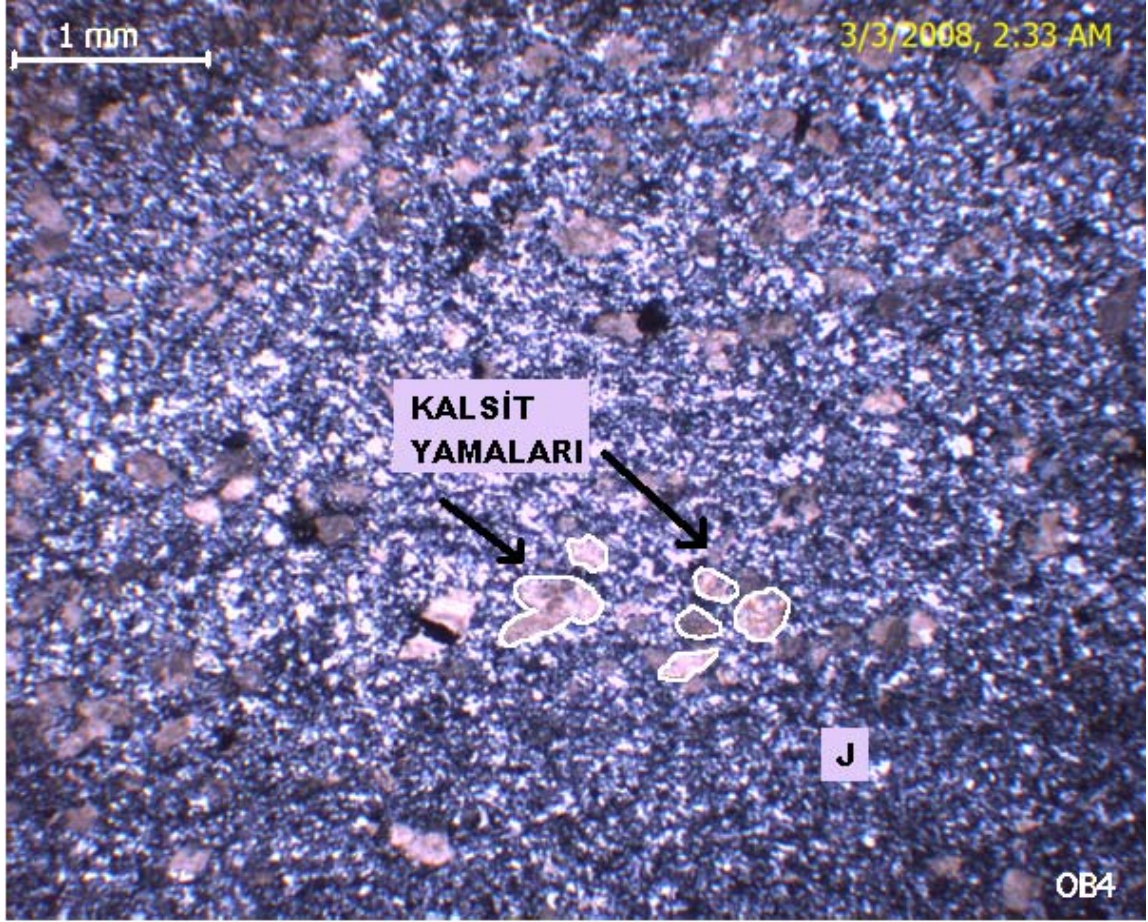
Şekil 5.3 İçerisinde bulunan karstik boşluklar kalsit yamaları ile doldurulmuş alabastrin dokulu jips. (OB-4 örneği, çift nikol 10x10)
