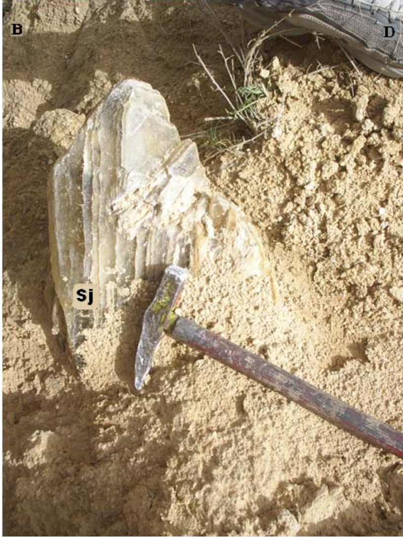
Şekil 4.15 Dikilitaş mevkiindeki Ef-6 fasiyesine ait selenitik jipslerin (Sj) arazi görünümü
