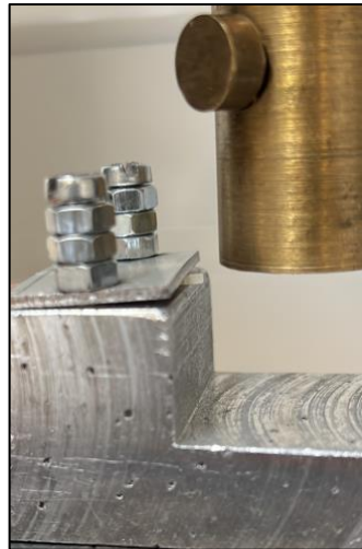
Şekil 2.14. Elde edilen çubuğun MMBD değeri test edilirken kurulan düzenek
