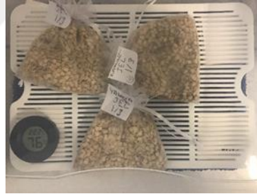
Şekil 3.7 Hava geçirimsiz kaplarda yapılan slika jel kurutma
