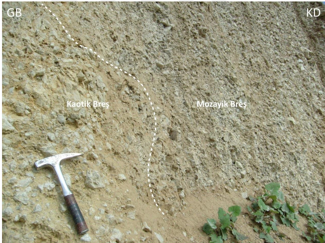
Şekil 3.21 GY-5 gözlem alanında (Bolu bölgesi) kaotik breş ile mozayik breş geçişinin yakın görünümü (Konum için şekil 3.11'e bakınız)
