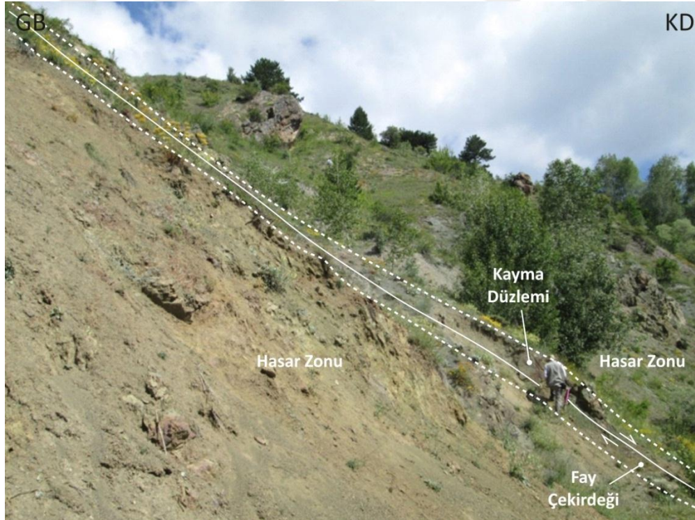
Şekil 4.14 GY-1 gözlem alanında (Alıç bölgesi) kataklastik zonun arazi görünümü (Konum için şekil 4.10'a bakınız)
