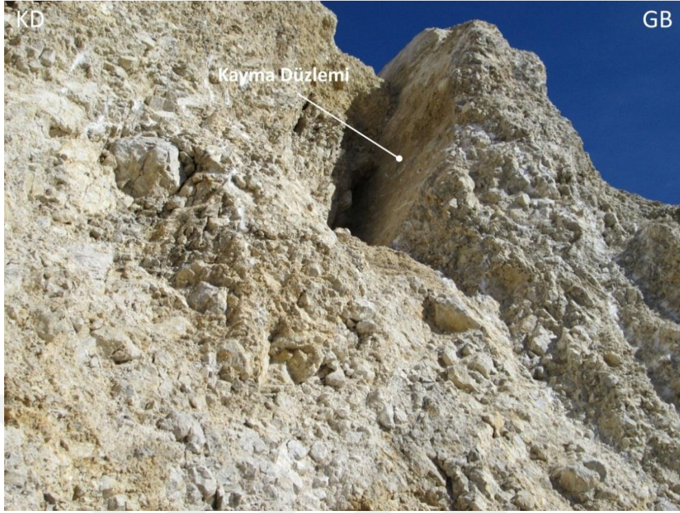
Şekil 4.27 GY-4 gözlem alanında (Arslantaş bölgesi) temel kaya içerisinde gelişen kayma düzleminin yakın görünümü (Konum için şekil 4.10'a bakınız)
