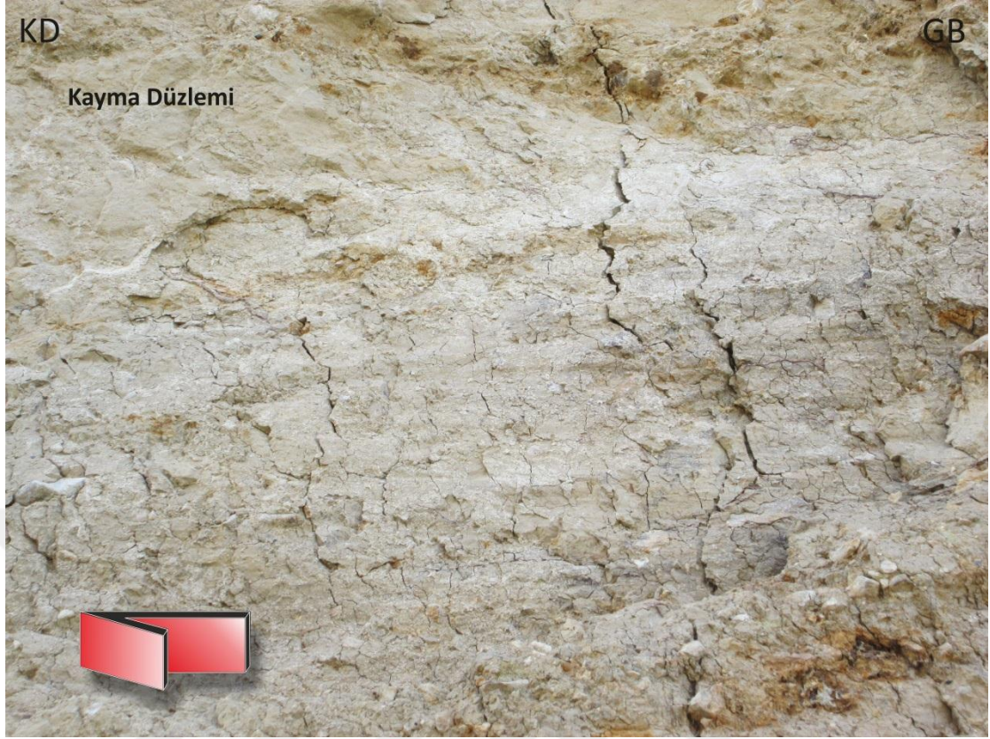
Şekil 3.38 GY-9 gözlem alanında (Hamamlı bölgesi) Kuvaterner çökellerde gelişmiş fay düzleminin yakın görünümü (Konum için şekil 3.11'e bakınız)
