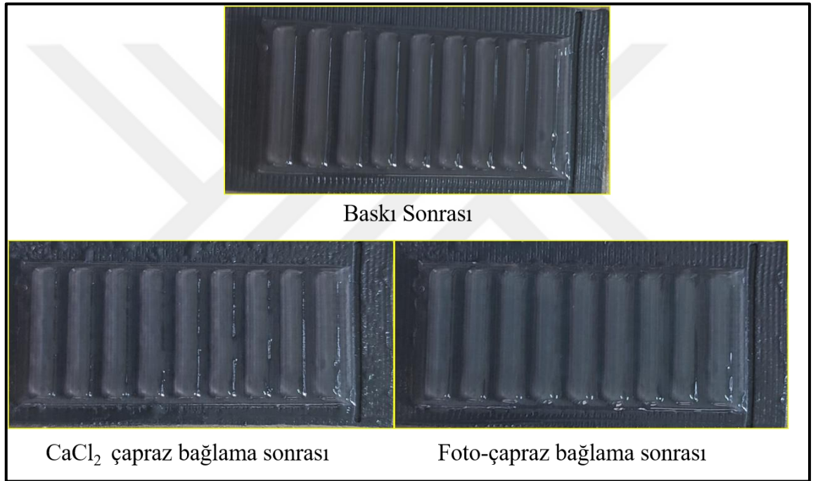
Şekil 5.23. 3B basımdan hemen sonra CaCl 2 püskürtmesi ile çapraz bağlama ve ardından mavi LED ışık kullanılarak foto-çapraz bağlama sonrası desenlerin durumu.
