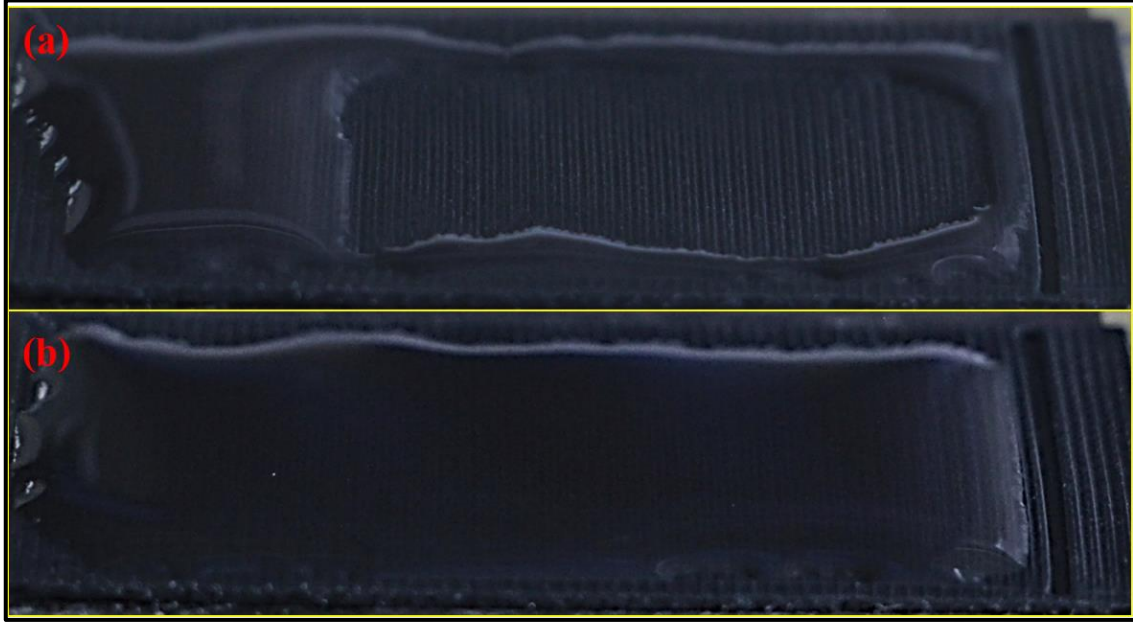
Şekil 5.19. GELMA20 hidrojelinin EcoFlex-APTES manyetik substrat üzerine 3B basımı. (a) Tabla sıcaklığı 23°C. (b) Tabla sıcaklığı 17°C
