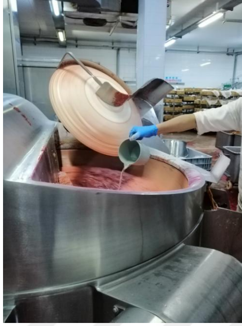
Şekil 2. 6. Sosis hamuruna askorbik asit eklenmesi aşaması
