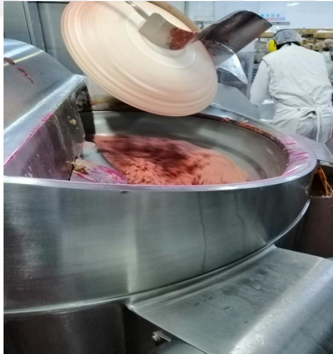
Şekil 2. 3. Sosis hamurunun kuterde hazırlanması aşaması
