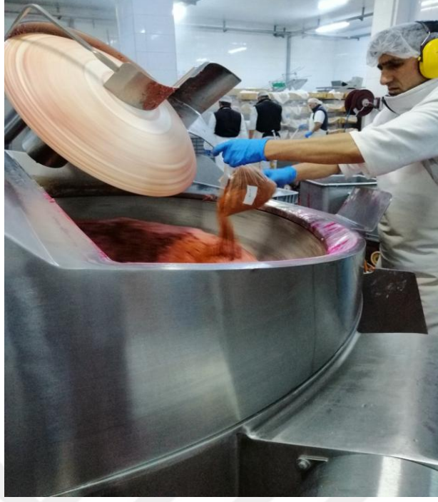
Şekil 2. 4. Sosis hamuruna baharatların eklenmesi aşaması
